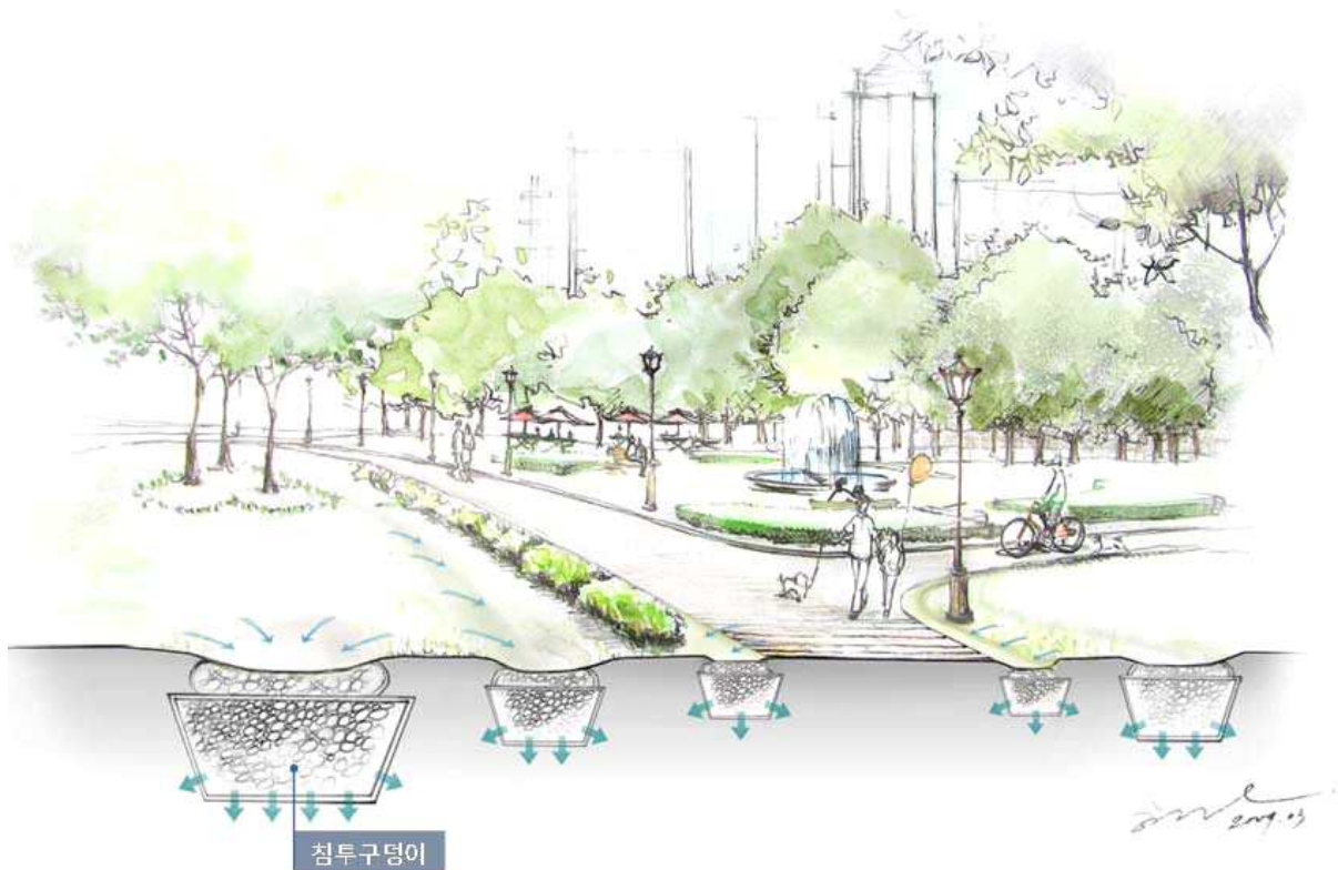
[그림 4.15] 공원의 침투시설 설치 구조
