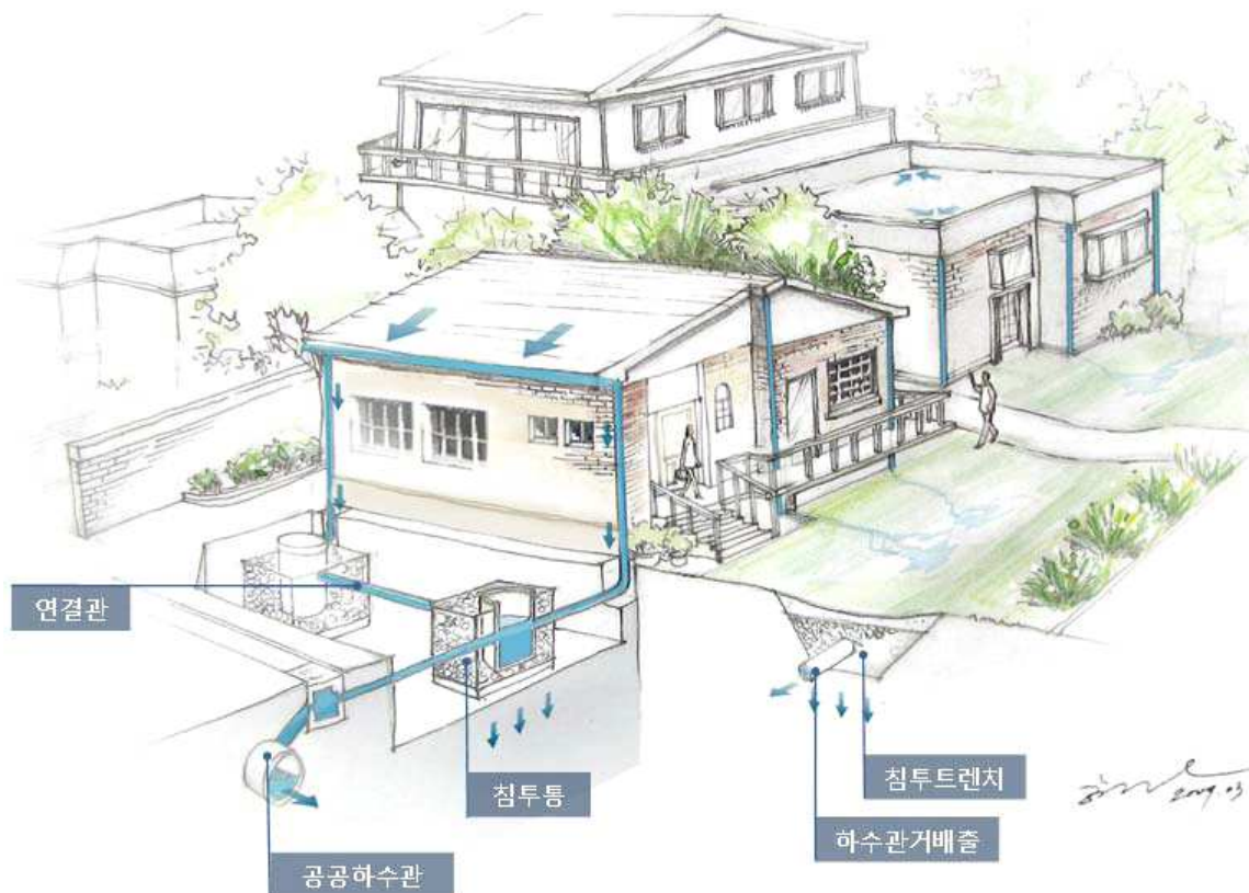
[그림 4.1] 단독주택의 침투시설 설치 구조
